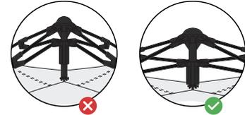
2. Stehen Sie hinten im Zelt und heben Sie die obere Stützstange des Zelt an. Drücken Sie dann die Stützstange hier unten.
