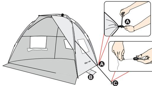
3. Setzen Sie die Zeltheringe in die 4 Ecken des Zelt ein (A). Sie können die Sandsäcke (B) mit Sand füllen, um die Stabilität des Zelt zu erhöhen. Und an windigen Tagen können Sie winddichte Seile (C) verwenden.
