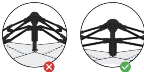
2. Stellen Sie sich hinten der Strandmuschel und heben Sie die obere Stützstange der Strandmuschel an. Drücken Sie dann hier die Stützstange nach unten.
